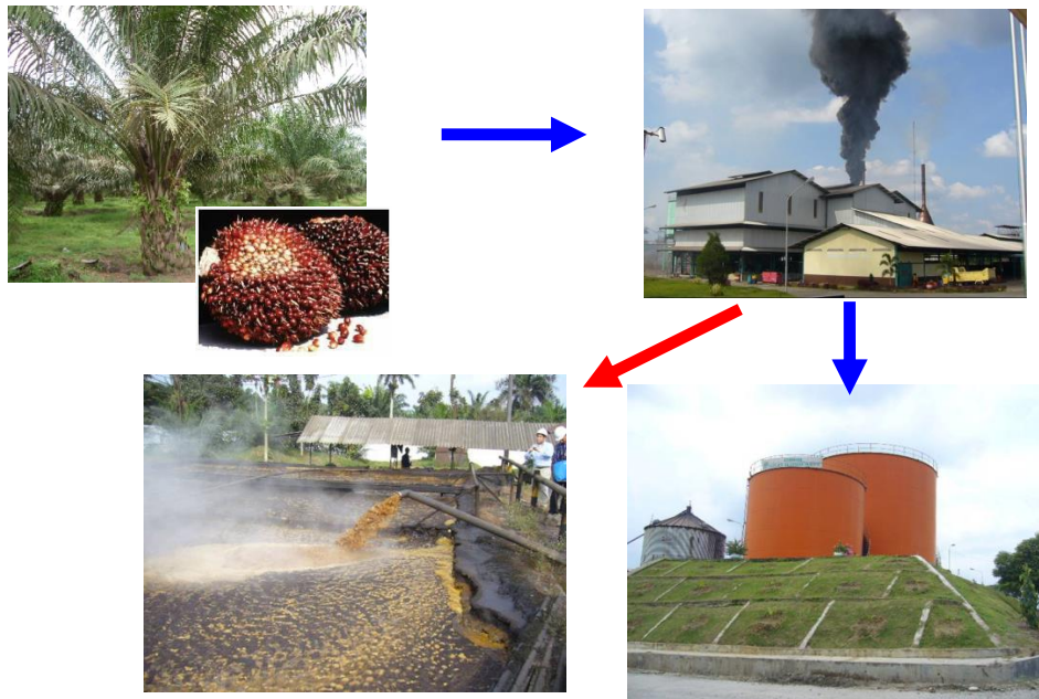
Gambar 1. Alur pengolahan kelapa sawit, menghasilkan CPO dan POME
