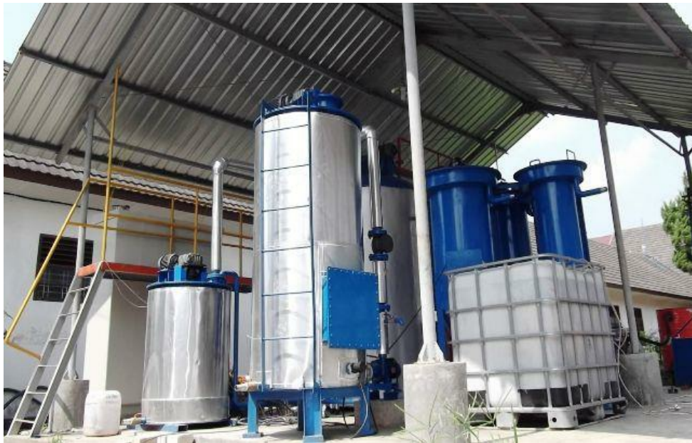
Gambar 4. Digester tangki tertutup skala pilot
