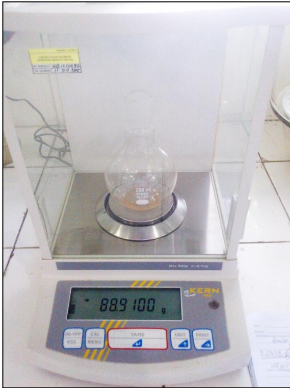
Hasil Ekstraksi Lemak Ditimbang Diatas Neraca Analitik
