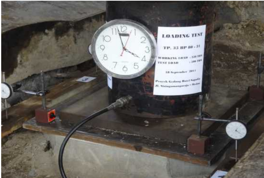
Pelaksanaan loading test dengan beban langsung ( Kentledge System ) pada pile no: 35 BP 80-31 yang dilaksanakan pada tanggal 18 September 2014
