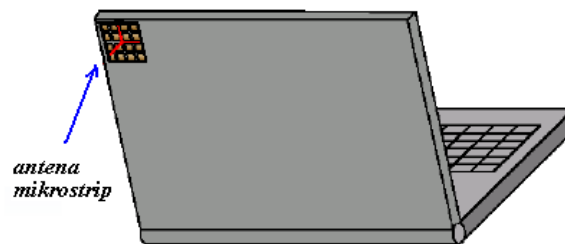
Gambar 1.2 Antena Mikrostrip pada Laptop (Abdel-Rahman, 2005).
