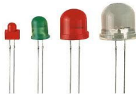
Gambar 2.20 Bentuk Fisik Dioda LED
