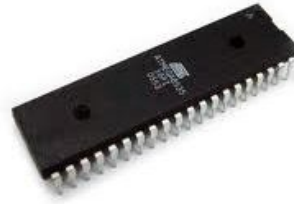
Gambar 2.6 Bentuk Fisik Mikrokontroler ATmega 8535
