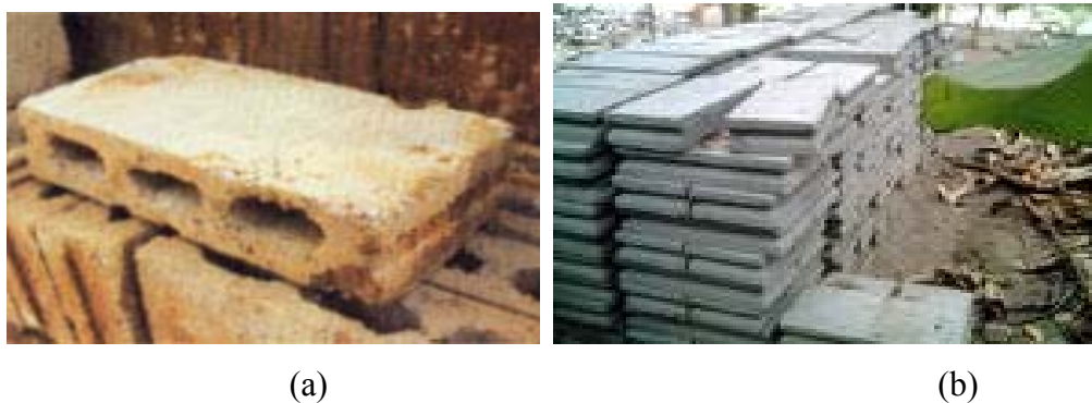
Gambar. 2.4. (a). Batako Berlubang ( Hallow ) dan (b) Batako Padat ( Solid )
